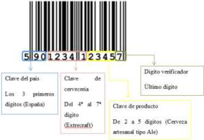
FIGURA 4.9: Sistema de identificación de los lotes elaborados en la microcervecería mediante código de barras. Fuente: GS1 México (2016).
