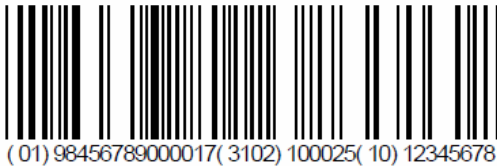
FIGURA 4.8: Ejemplo código GS1-128. Fuente: Manual de implantación de los estándares EAN-UCC (Cerveceros de España, 2004).
