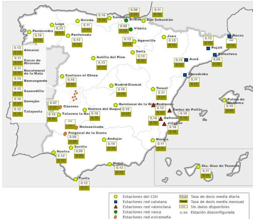
Figura 2. Valores medios diarios y mensuales de la tasa de dosis equivalente ambiental registrada en las diferentes estaciones automáticas de la REA y las Redes de Alerta Autonómicas [CSN_REA,2020].
