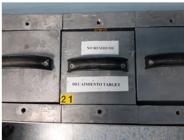
Figura 5.1. Contenedor de plomo donde se almacena el ánodo retirado durante los mantenimientos.
