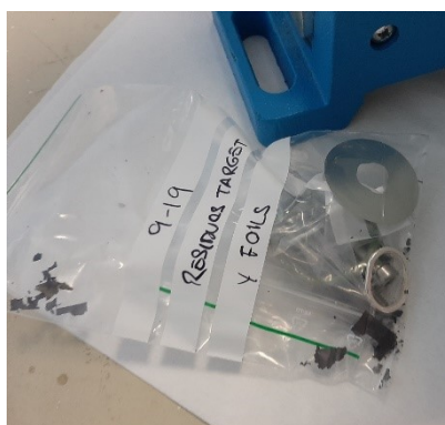
Figura 5.8. Bolsa de residuo 10.19 conteniendo las láminas de Havar™ y titanio y la junta Helicoflex™.
