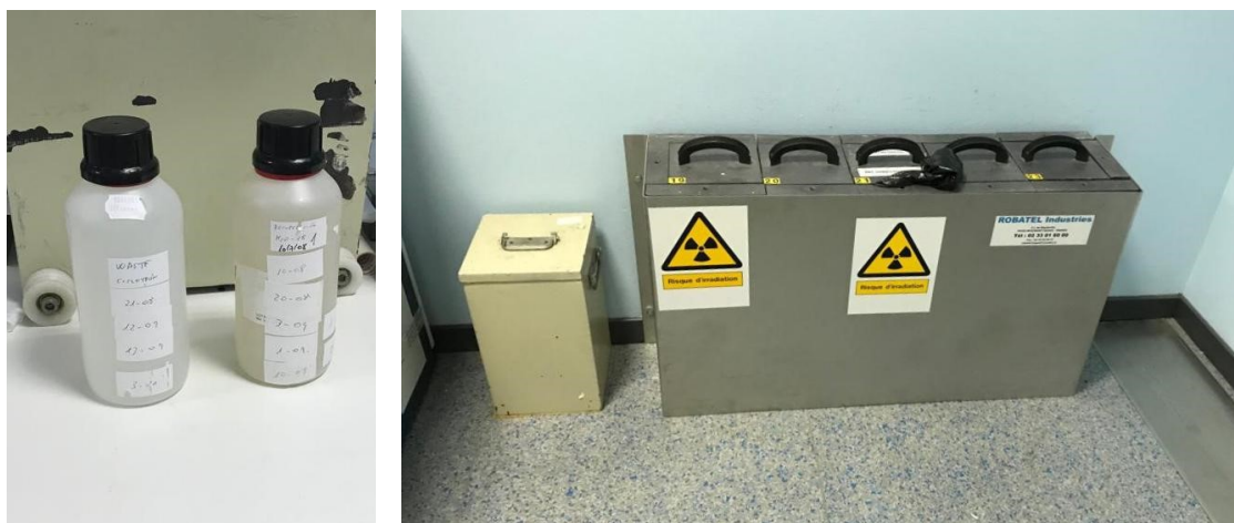
Figura 4.1. Contenedores (CONT1 y CONT2) de agua enriquecida recuperada y depósitos de plomo donde son almacenados en el interior del búnker del ciclotrón.
