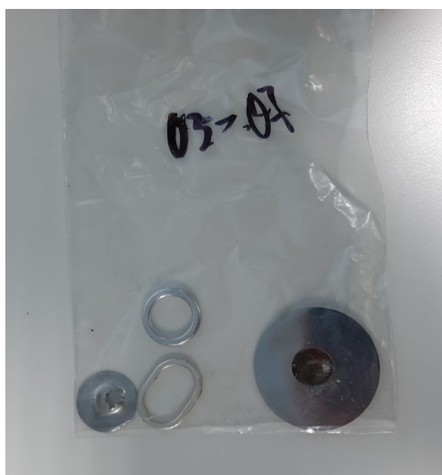
Figura 5.2. Lámina de Havar™, junto a lámina de Ti y juntas, en bolsa de residuos.
