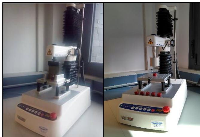
Figura 11. Determinación de textura con texturómetro (Stable Microsystems TA. XT Plus, Godalming, U.K.). Sonda Warner-Bratzler y sonda cilíndrica de compresión (P/50).
