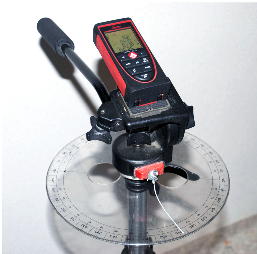
Figura A.2: Instrumento utilizado en el levantamiento topográfico de las bóvedas
