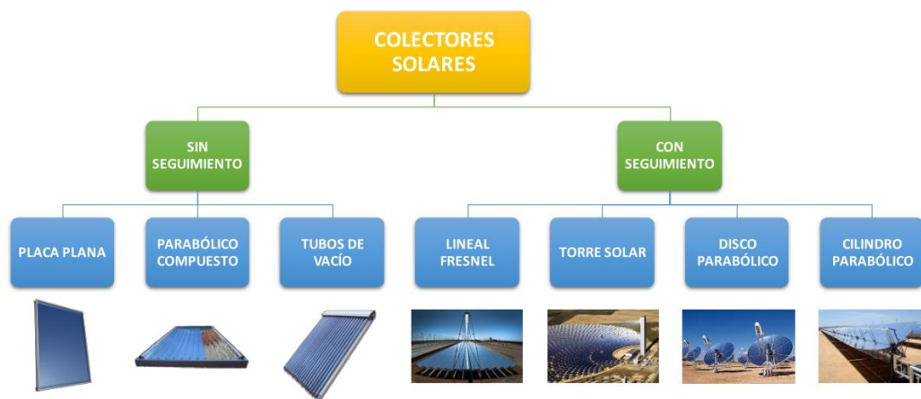
Figura 18. Clasificación de los colectores solares atendiendo al seguimiento. [23]
