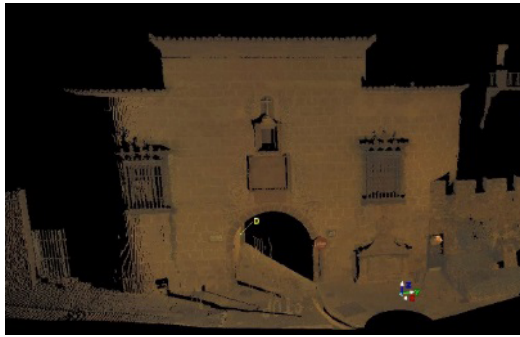
Figura 2. Nube de puntos de la Ciudad Monumental de Plasencia. Procesada en el Software Cyclone. Elaboración Propia.
