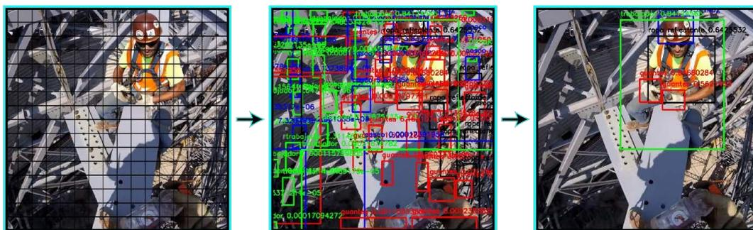
Figura 2.2: Metodología propuesta: de izquierda a derecha, (1) dividir imagen en bloques de 13x13 px, (2) hacer predicciones con YOLO re-entrenado y (3) establecer umbrales para obtener solo detecciones más fiables.
