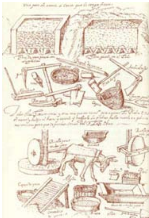
Horno de yeso y útiles necesarios para la cocción y tratamiento del mismo 601
