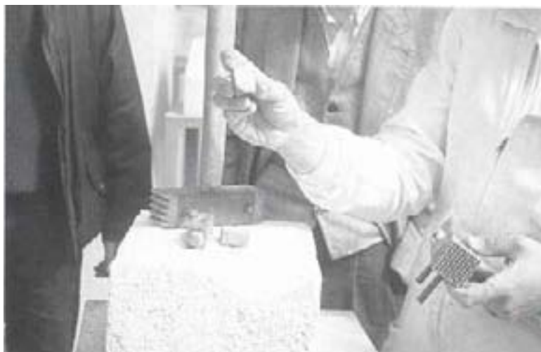
La bujarda es un instrumento que sustituirá al trinchante en el siglo XIX
