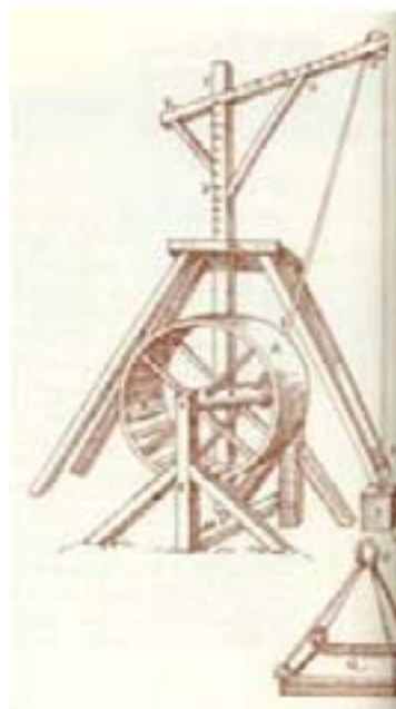
“La grúa es un instrumento de madera, que sirve para elevar las piedras de las bras...” 807
