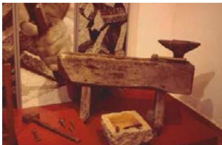
Herramientas para el desbaste de la piedra. Museo de Cantería de Quintana de la Serena (Badajoz)
