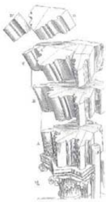
Arranque de los nervios de la bóveda de crucería sobre una ménsula, en la iglesia de Santo Domingo de Trujillo y detalle de las distintas piezas del jarjamento 684
