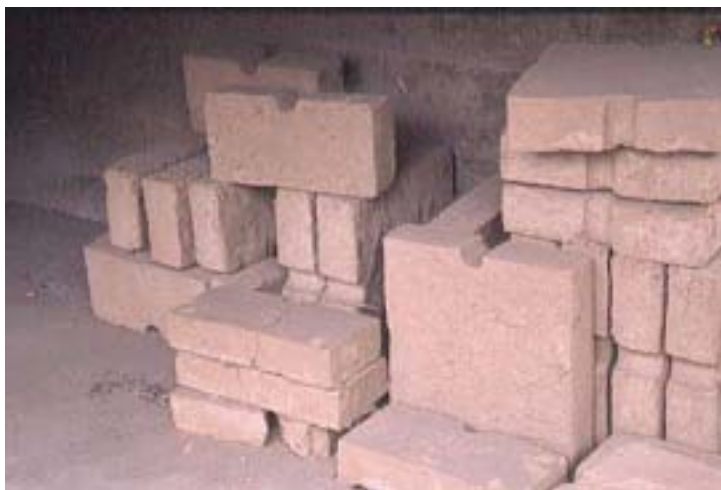
Ladrillos fabricados en adobe. (Universidad Nacional de Lima)
