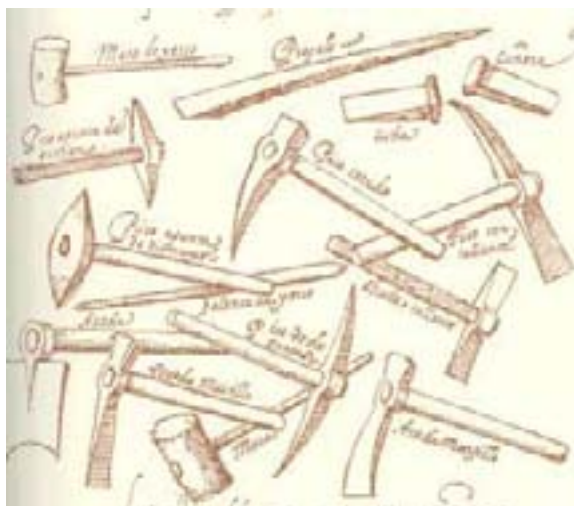
Instrumentos de extracción y desbaste. Gráfico del libro de Juanelo Turriano 761
