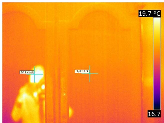
Figura 33.- Imagen infrarroja de las dos cristales de una puerta (elaboración propia).
