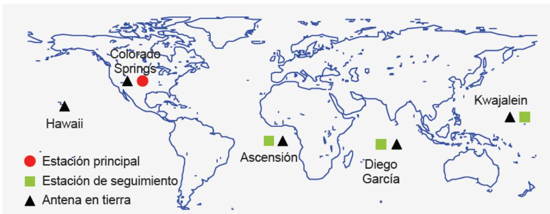
Figura 10.- Segmento de control GPS (Colorado, 2013).
