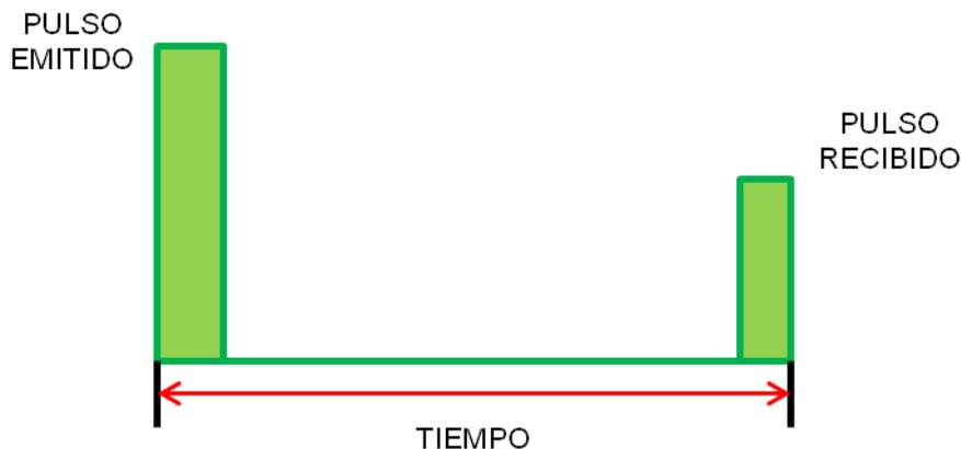
Figura 23.- Medición láser por pulsos (Elaboración propia).
