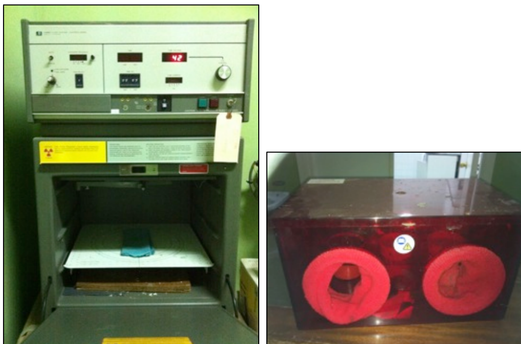
Figura 2.12: Aparato para radiografías de pequeños animales y muestras pequeñas del modelo Faxitron (izquierda) y reveladora (derecha).
