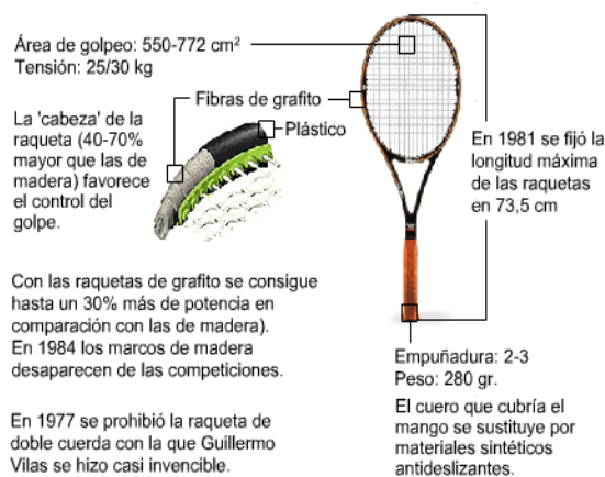
Estructura de la raqueta de grafito, 1980
