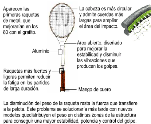
Estructura de la raqueta de metal, 1967
