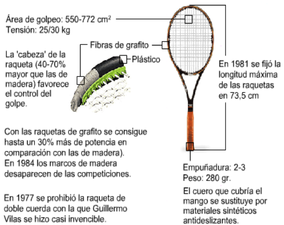
Estructura de la raqueta de compuesta, 2003
