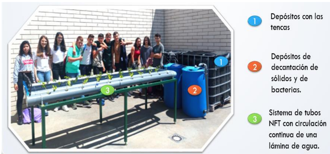
Figura M 7. Sistema Acuapónico. Puesta en funcionamiento del sistema por los alumnos de 3º ESO de la asignatura de Laboratorio de Ciencias, tras el plantado en el sistema NFT de las plántulas obtenidas de los semilleros.
