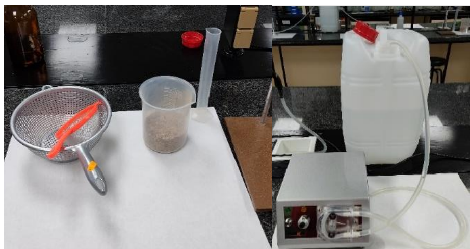
Figura 58. Materiales necesarios para la construcción del filtro lento de arena
