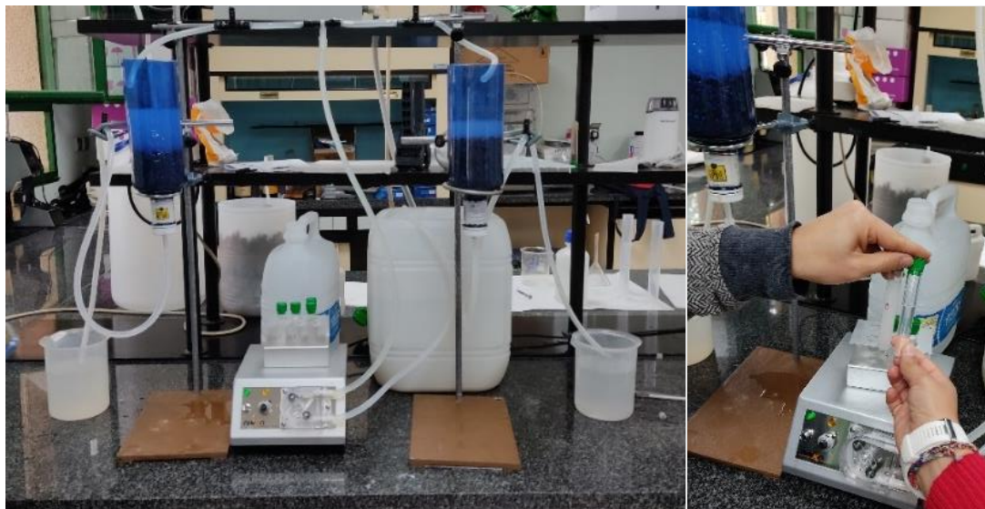
Figura 62. Instalación final del filtro lento de arena y comparación cualitativa de dos muestras de agua
