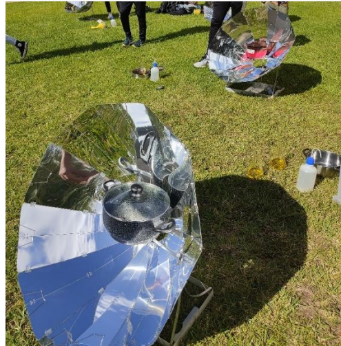
Figura 66. Montaje de una cocina solar
