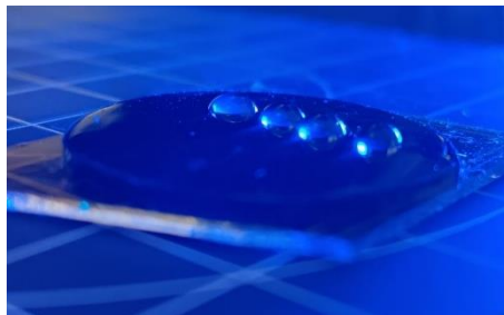
Figura 3.10. Gotas de agua desionizada sobre una ácido poliláctico fijada en vidrio.
