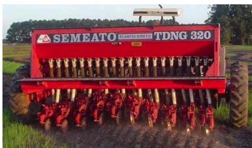
Figura 1.4: Máquina empleada para realizar la siembra directa en el cultivo de cereal. Modelo Semeato TDNG320.
