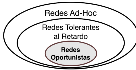
Figura 2.3: Agrupamiento de las redes oportunistas en el contexto de la comunicación ad-hoc.
