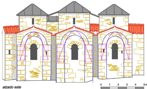
Imagen 120: Sistema en equilibrio en el triple ábside (elaboración propia).
