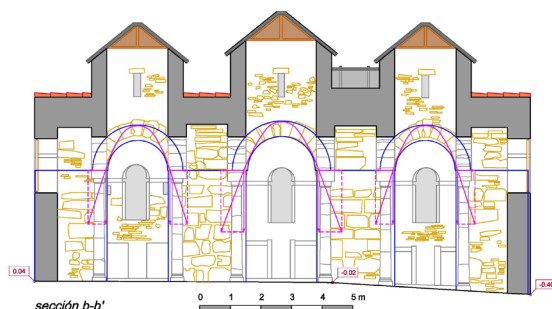
Imagen 119: Sistema en equilibrio en los arcos de embocadura de los tres ábsides (elaboración propia).
