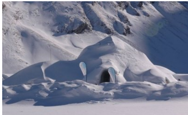
Fotografía 197: Iglú construido al modo tradicional, aprovechando capas de nieve sucesivas como mejora de su aislamiento (ilustración de Arquitectura Vilssa)
