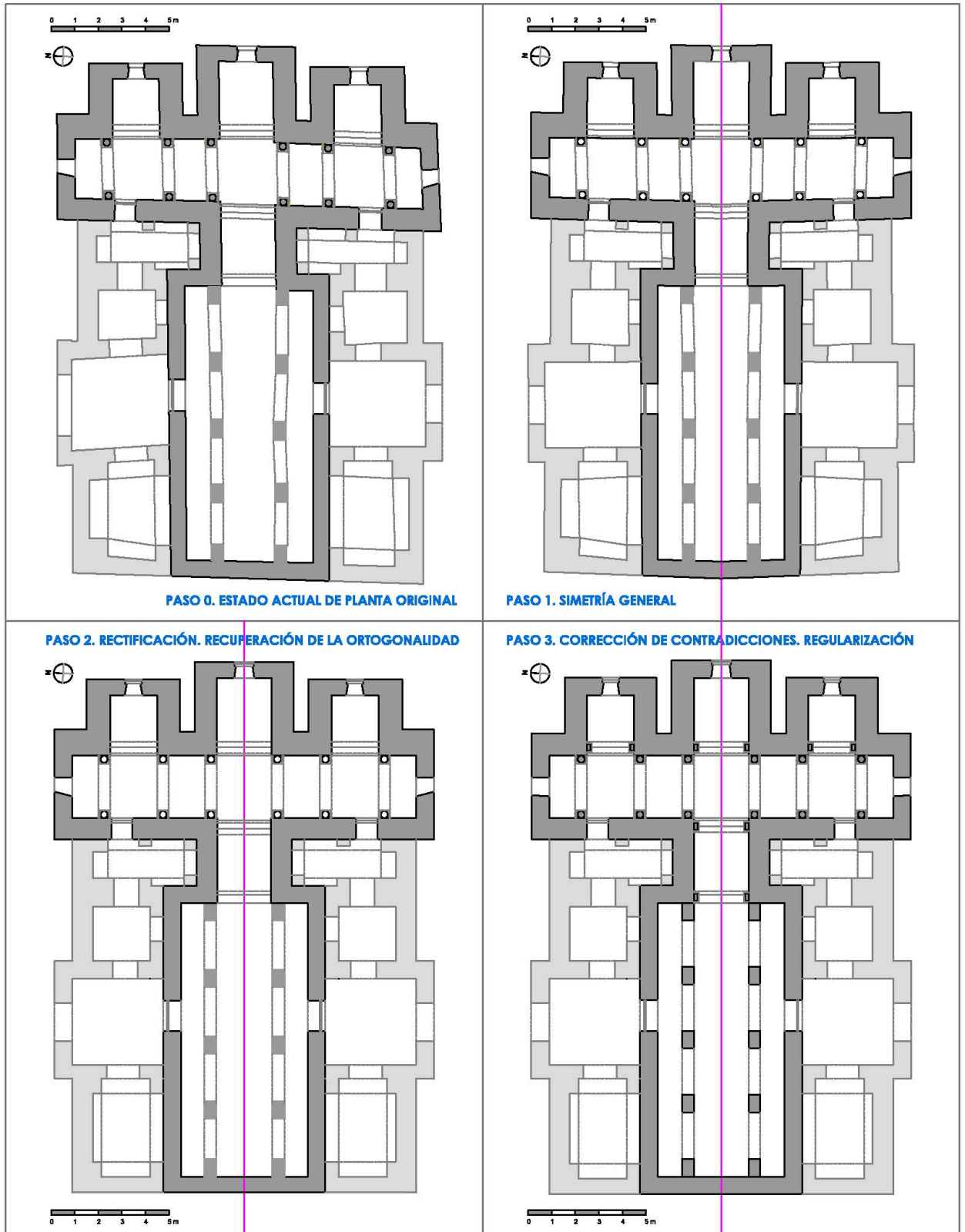
Imagen 062: Rectificación de la Traza original siguiendo el procedimiento establecido en la metodología (elaboración propia).
