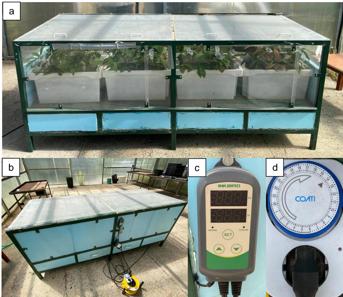
Figura 12. Cámara climática ubicada en el invernadero de metacrilato del Centro Universitario de Plasencia: vista anterior con plantas perteneciente al bloque de estrés térmico (4 bandejas de la derecha) y estrés térmico + hídrico (4 bandejas de la izquierda) (a), vista posterior (b), termostato (c) y temporizador (d).
