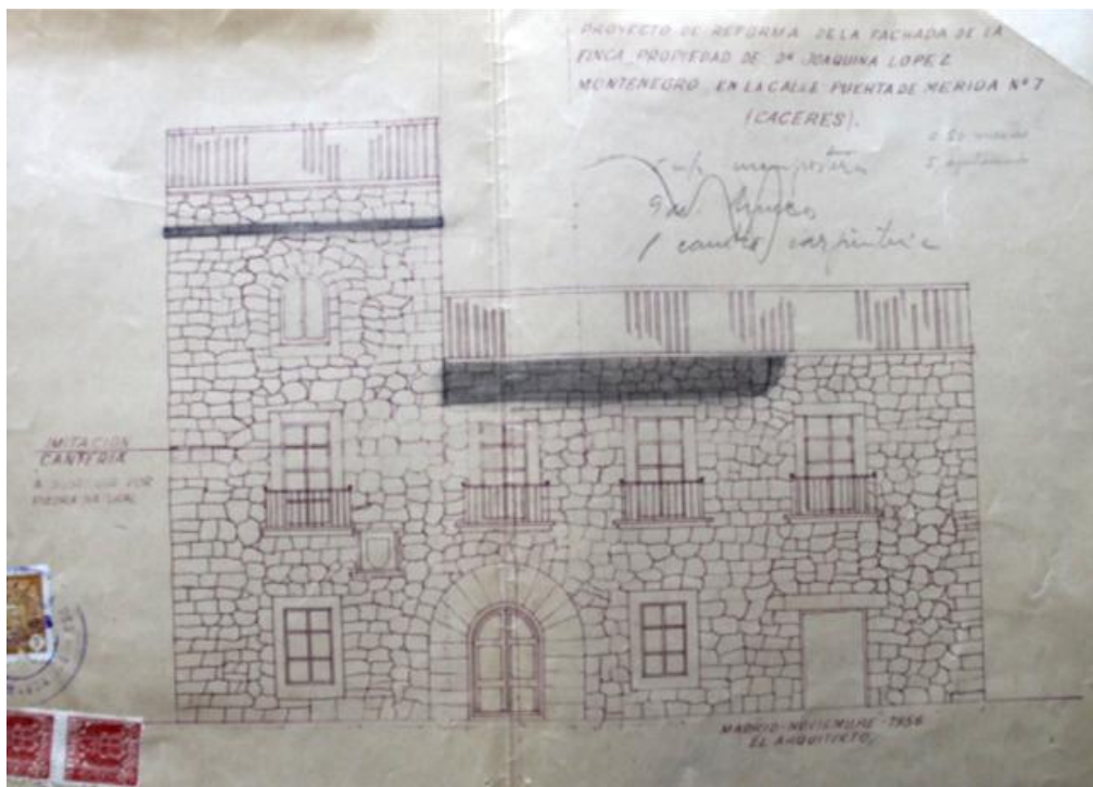
103. Plano presentado para la modificación de los cercos y tozas de los balcones, así como la sustitución de la mampostería de la torre por piedra natural (AMC).
