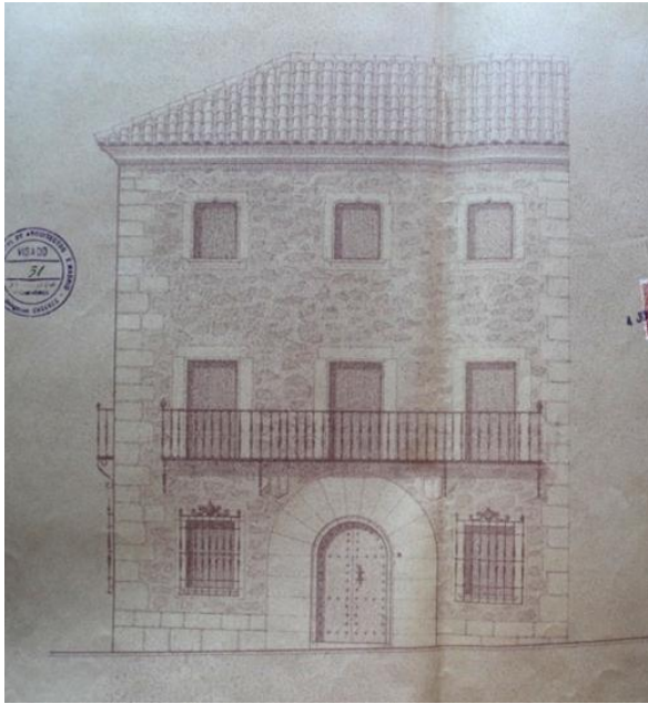
86. Primer alzado presentado para intervenir en la casa de la calle Ancha nº 8 en junio de 1952, que fue rectificado a través del alzado de la derecha, en el que encontramos una evidente simplificación en los elementos exteriores de la vivienda: se elimina el balcón corrido proyectado, así como la portada de medio punto y las rejas laterales de imitación antigua (AMC).
