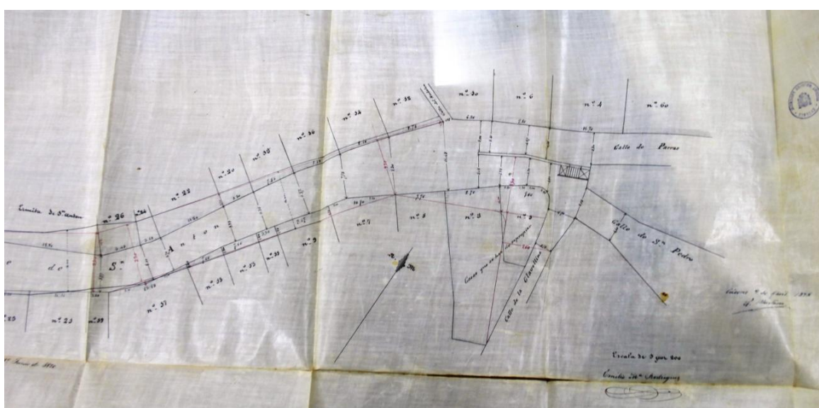
67. Proyecto de ensanche de la calle San Antón, firmado en 1880 por Emilio M a Rodríguez. Se rectifica la alineación de la calle para facilitar el tránsito hacia la nueva estación de ferrocarril, situada en el actual Paseo de Cánovas(AHPC).
