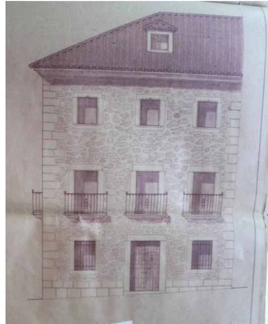
86. Primer alzado presentado para intervenir en la casa de la calle Ancha nº 8 en junio de 1952, que fue rectificado a través del alzado de la derecha, en el que encontramos una evidente simplificación en los elementos exteriores de la vivienda: se elimina el balcón corrido proyectado, así como la portada de medio punto y las rejas laterales de imitación antigua (AMC).
