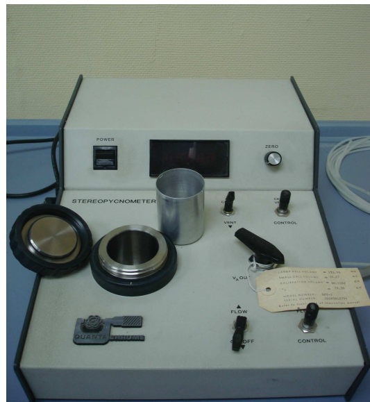
Figura 3.1. Estereopícnómetro de helio Quantachrome SPY-3 y celda calibrada.
