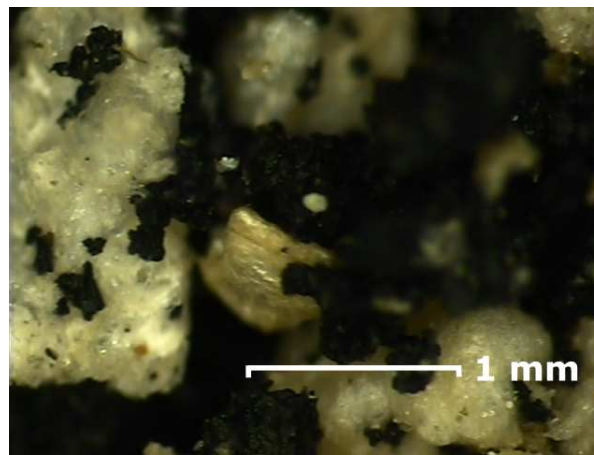
Figura 4.12. Microfoto de la muestra M-1 obtenida con una máquina de visión digital Mitutoyo Vision Machine en donde se pueden apreciar las partículas de caucho, EPS y vermiculita
