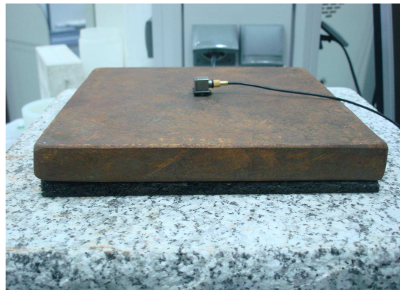
Figura 3.3. Disposición del ensayo para la determinación de la frecuencia de resonancia de la lámina elástica según UNE EN 29052-1.
