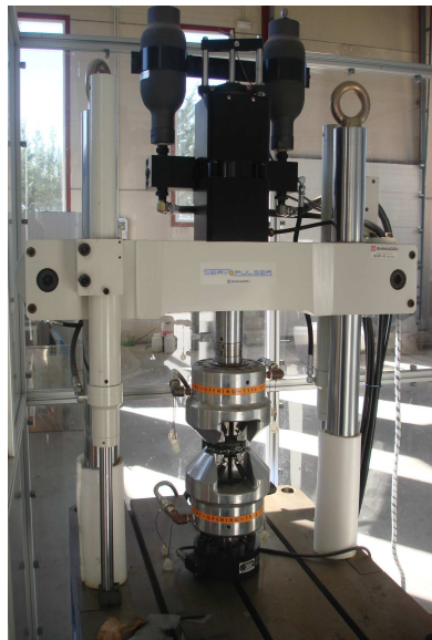
Figura 3.5. Prensa Shimadzu SERVOPULSER Serie universal U Frame Body empleada para la determinación de la compresibilidad.
