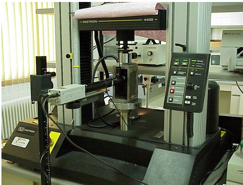
Figura 4.4: Esquema del montaje y fotografía del sistema de observación in situ.
