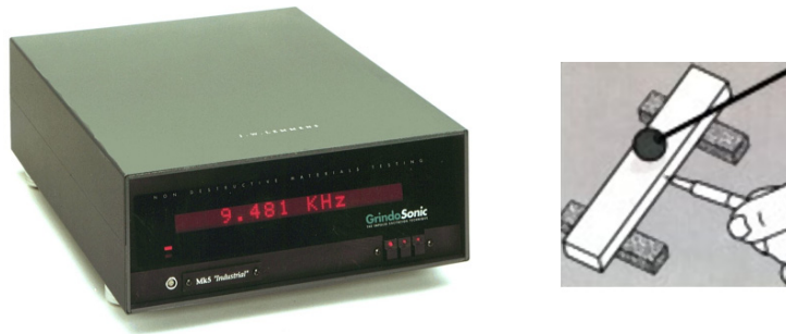
Figura 4.7: Instrumento de medida de la frecuencia natural de vibración y esquema de utilización.
