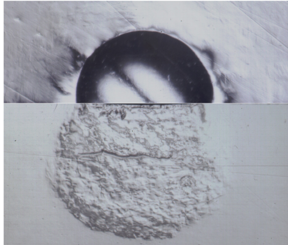
Figura 1.15: Deformación plástica generada en un acero blando sometido a un ensayo Hertz. Micrografías obtenidas a partir de muestras preparadas mediante de la técnica de intercaras unidas (bonded-interface) [43,44] . Imagen superior: superficie del material. Imagen inferior: sección.
