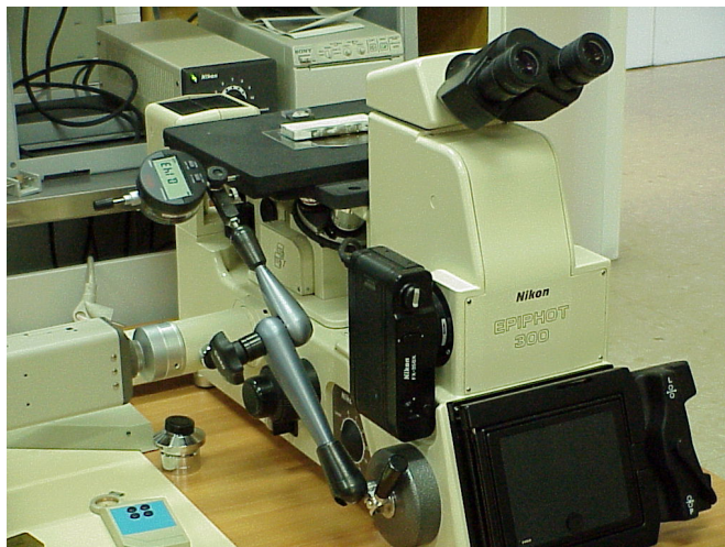
Figura 4.3: Microscopio óptico invertido Nikon Epiphot 300 y reloj-comparador acoplado.
