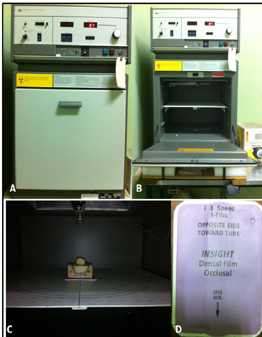
Figura 36: Imágenes del Faxitron en el animalario. A y B: Imagen del Faxitron para realizar las radiografías. C: Imagen interior del Faxitron con la falange sobre la plataforma rotatoria. D: Imagen del tipo de película fotográfica utilizada para realizar las radiografías.
