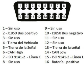
Figura 1.1 Terminales del dispositivo OBDII
