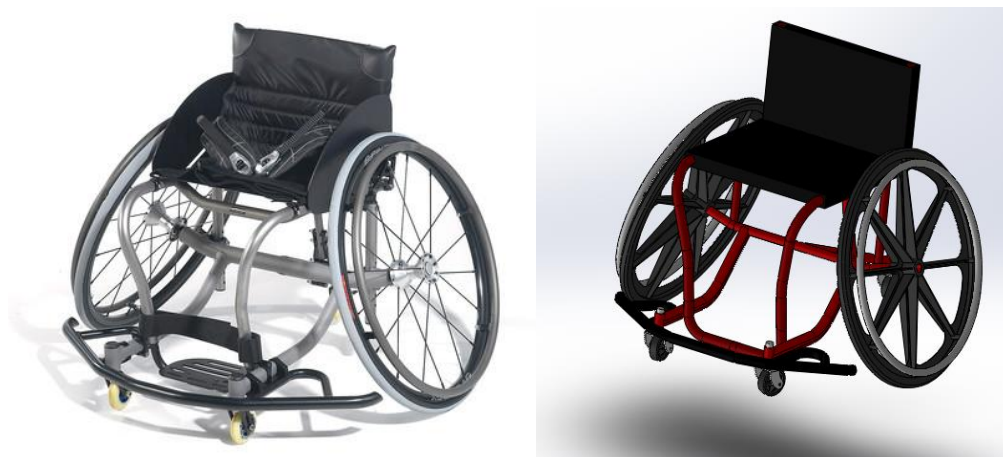
Figura 1.1 Silla de ruedas real (izquierda) y creada en Solidworks (derecha).
