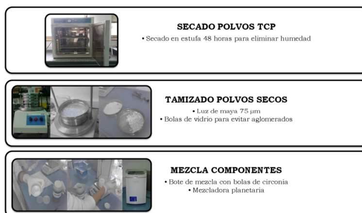
Fig. 2.5: Esquema del proceso de fabricación de tinta para la posterior fabricación de barras individuales y andamiajes mediante moldeado robotizado.
