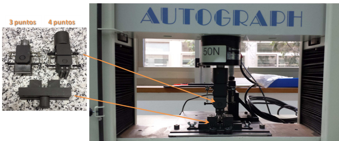
Fig. 2.29: Máquina de ensayos universal (SHIMADZU) y dispositivo para la realización de los ensayos de flexión en tres y cuatro puntos.
