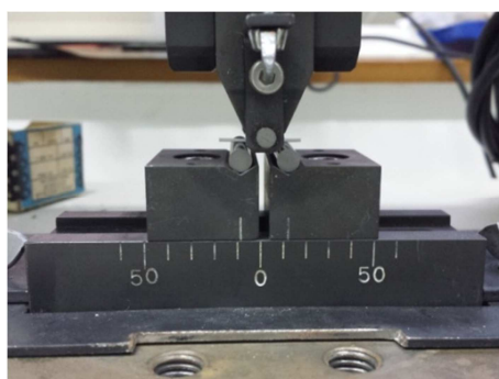
Figura 2.30: Barra individual sometida a un ensayo de flexión en tres puntos.
