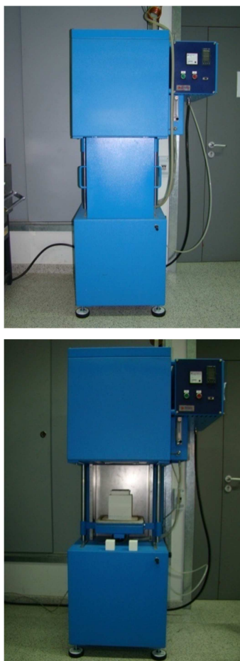
Fig. 2.16: Horno tipo ascensor en el que se ha realizado la sinterización de las estructuras porosas cerámicas.
