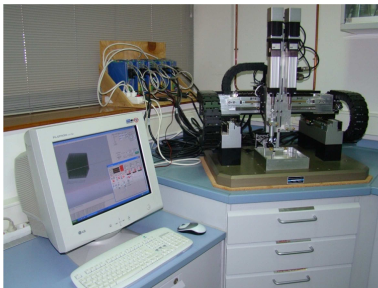
Fig. 1.17: Equipo de impresión en tres dimensiones (ROBOCASTING).
