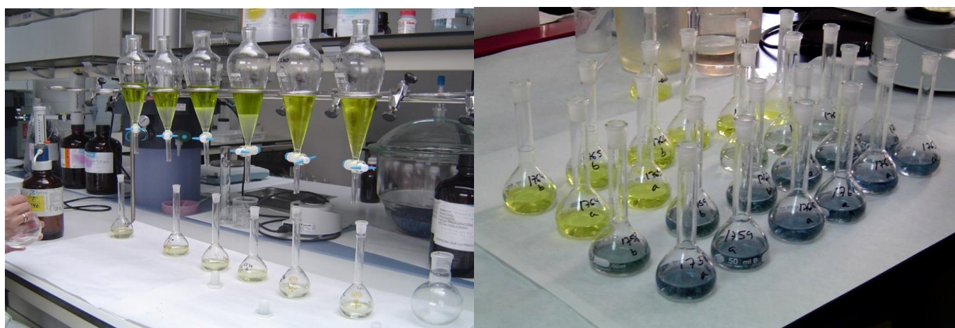
Figura III.14. Extracción del extracto fenólico (foto de la izquierda) y reacción con Folin-Cicalteau (foto de la derecha). Fuente: INTAEX.
