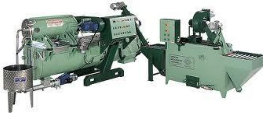
Figura III.5. Línea de extracción de aceite de oliva virgen PEGASO 500. Fuente: Cesma SL.
