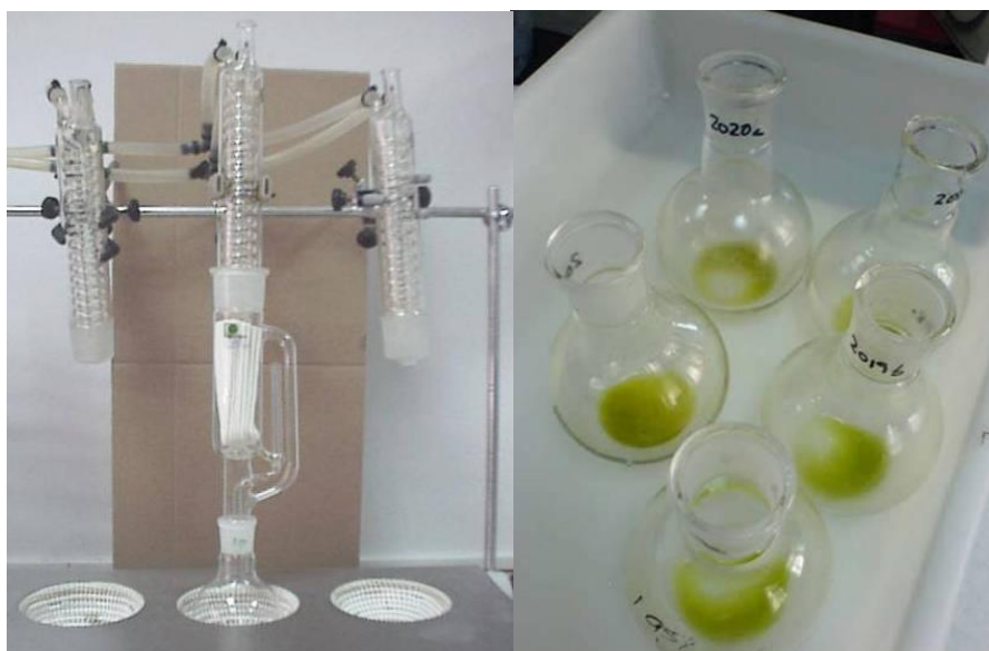
Figura III.8. Extractor Soxhlet y matraces con la grasa extraída. Fuente: INTAEX.
