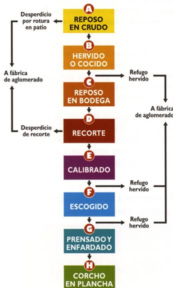
Figura 1.4.1. Esquema del proceso de preparación de corcho en plancha (Ávila et al., 1998)
