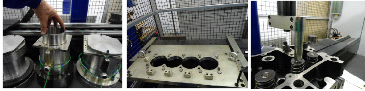
Figura 3.3: Detalle de los elementos mecánicos que generan incertidumbre en la posición relativa de la culata respecto al banco de flujo, o en la posición de la válvula durante el ensayo. La figura muestra el cilindro adaptador de diámetro 96 mm (izquierda), la plancha de posicionamiento de la culata (centro), y el sistema de apertura de la válvula (derecha).
