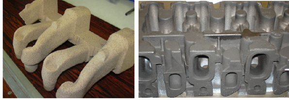
Figura 2.2: Macho de la culata objeto de estudio (izquierda). Pipas de admisión y escape una vez fundida la culata (derecha).
