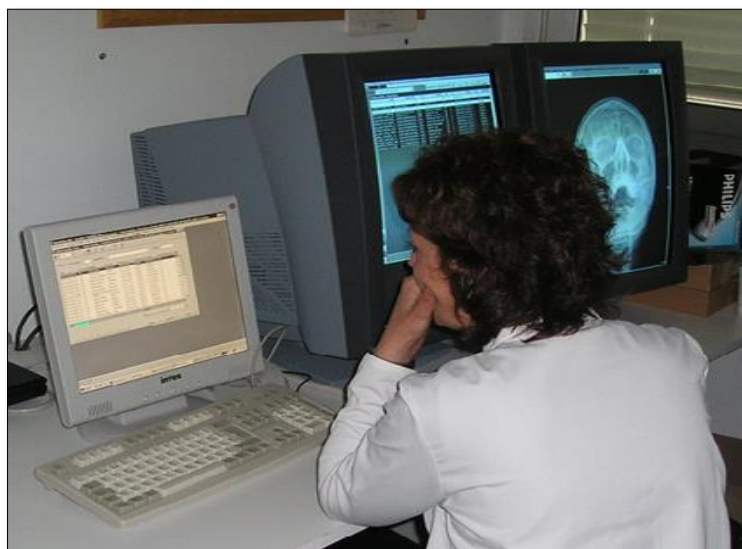
Figura 3.11 Estación de diagnóstico primario, con monitores de alta resolución y otro para uso RIS.
