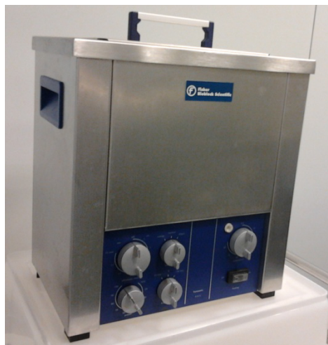
Figura 22 - Equipo de ultrasonidos empleado en la experiencia.
