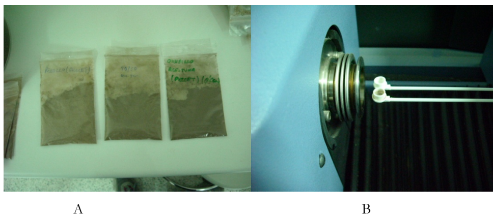
Figura 7 - Muestras obtenidas tras molienda (A) y una vez introducidas en termobalanza (B).
