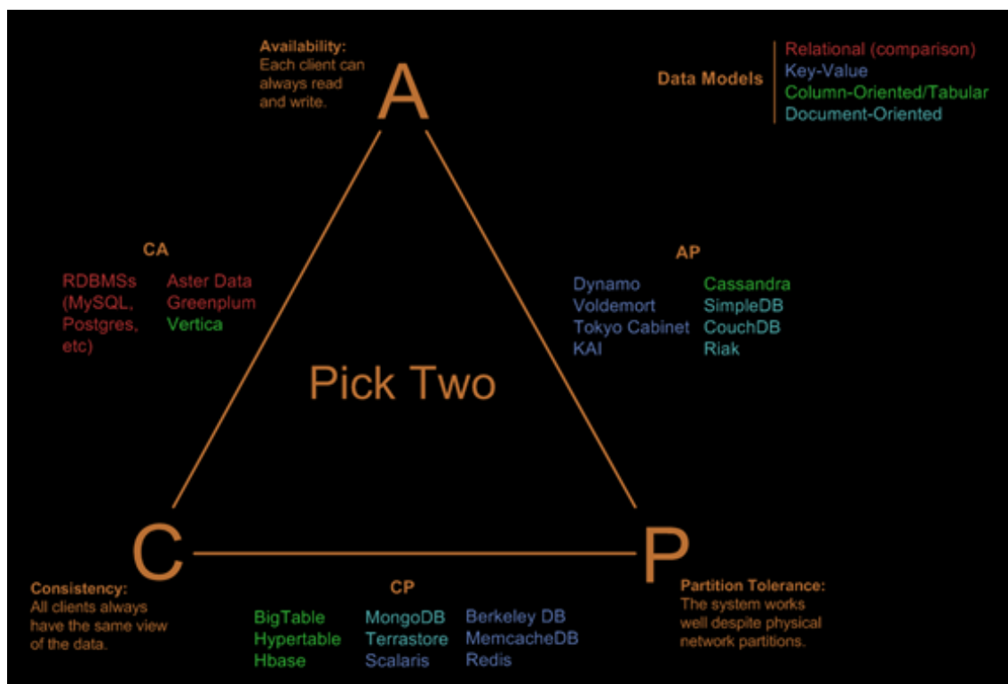
Figura 3 -. Teorema CAP y bases de datos NoSQL asociadas según cumplan unas u otras propiedades [20]
