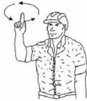
5 Levantar el aguilón o pluma y bajar la carga.
