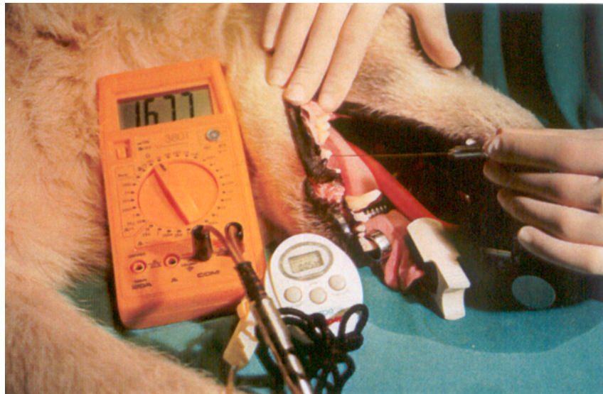
FIGURA 6.-SONDA TERMOMETRICA CONECTADA AL MEDIDOR DE RESISTIVIDAD
