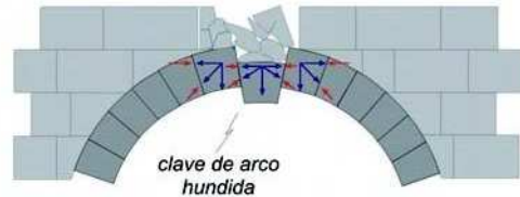
Figura 247. Estado final deformado. Giner-Robles et al. (2011)
