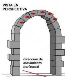
Figura 259. Esquemas idealizados del análisis de la deformación en arcos. Giner-Robles et al. (2011).
