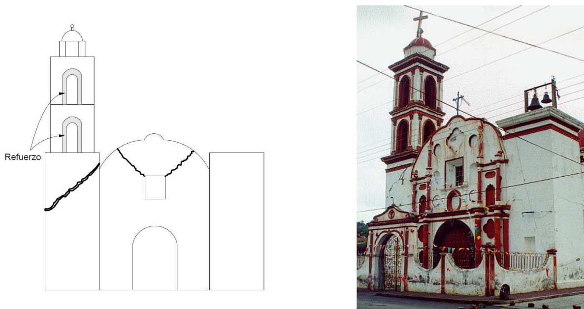
Figura 36. Esquema y vista general del daño exterior. (Alcocer et al., 1999).
