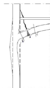
Figura 310. Pandeo del muro y desplazamiento local de la bóveda.
