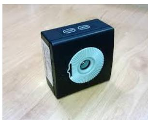
Ilustración 16: Calibrador de la firma Brüel & Kjaer
