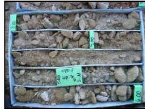
Foto-27: Perfil litológico obtenido en el sondeo SR-3 Prof.: 3,00 - 6,00 m.
