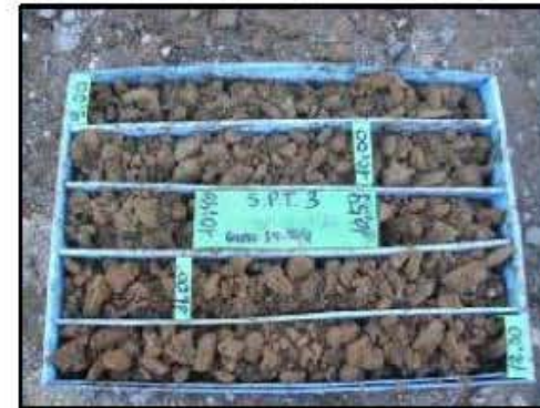
Foto-59: Perfil litológico obtenido en el sondeo SR-6 Prof.: 9,00 -12,00 m.
