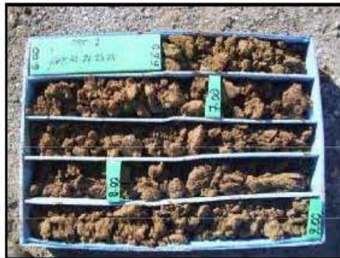
Foto-19: Perfil litológico obtenido en el sondeo SR-2 Prof.: 6,00 - 9,00 m.
