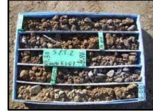
Foto-47: Perfil litológico obtenido en el sondeo SR-5 Prof.: 3,00 - 6,00 m.
