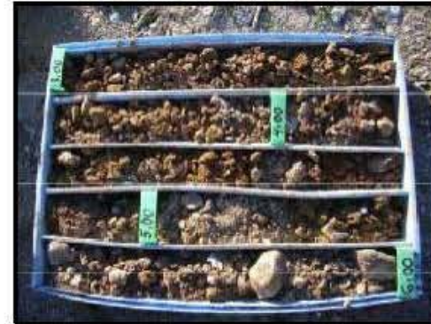
Foto-57: Perfil litológico obtenido en el sondeo SR-6 Prof.: 3,00 -6,00 m.
