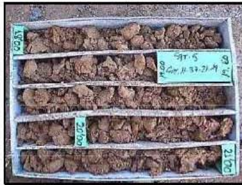
Foto-42: Perfil litológico obtenido en el sondeo SR-4 Prof.: 18,00 - 21,00 m.
