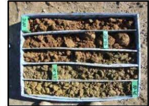
Foto-53: Perfil litológico obtenido en el sondeo SR-5 Prof.: 21,00 - 24,00 m.
