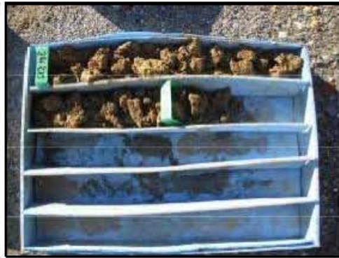
Foto-64: Perfil litológico obtenido en el sondeo SR-6 Prof.: 24,00 -25,00 m.
