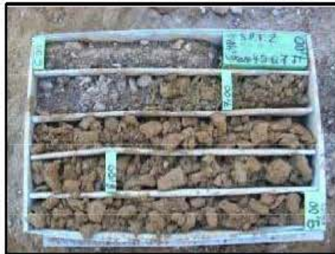
Foto-58: Perfil litológico obtenido en el sondeo SR-6 Prof.: 6,00 -9,00 m.
