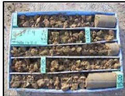
Foto-12: Perfil litológico obtenido en el sondeo SR-1 Prof.: 12,00 -15,00 m.
