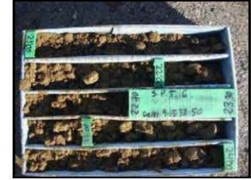
Foto-63: Perfil litológico obtenido en el sondeo SR-6 Prof.: 21,00 -24,00 m.
