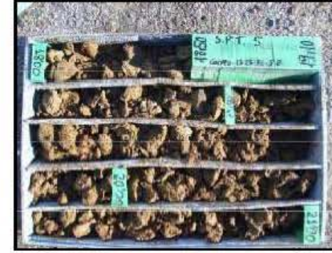
Foto-62: Perfil litológico obtenido en el sondeo SR-6 Prof.: 18,00 -21,00 m.
