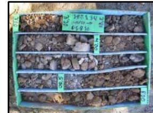
Foto-37: Perfil litológico obtenido en el sondeo SR-4 Prof.: 3,00 -6,00 m.
