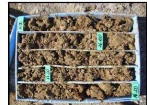
Foto-22: Perfil litológico obtenido en el sondeo SR-2 Prof.: 15,00 - 18,00 m.
