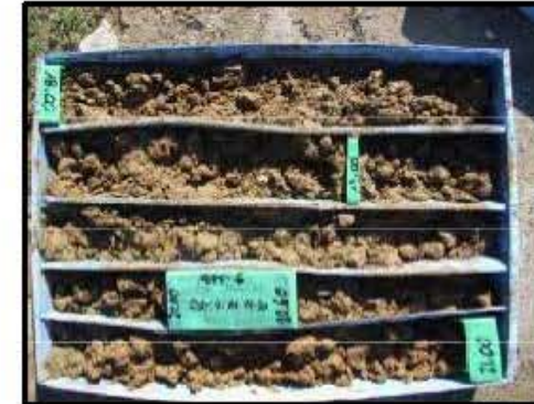
Foto-52: Perfil litológico obtenido en el sondeo SR-5 Prof.: 18,00 - 21,00 m.
