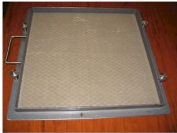
Figura 3.2. Vistas del filtro de captación de aerosoles de alto flujo.
