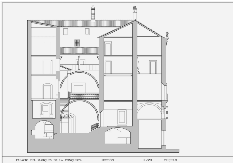
PLANOS 4 Y 5. Planta baja y sección por el patio del palacio de La Conquista (M. Sanz).
