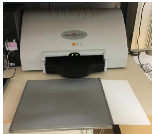
Figura 8. Conjunto fósforo-chasis OREX PoRT, digitalizador KODAK Point-of-Care 140CR
