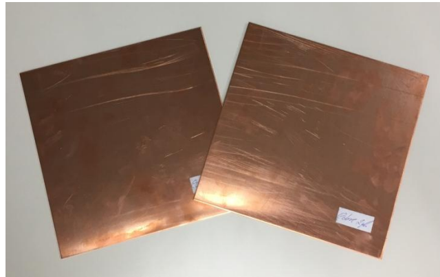
Figura 13. Láminas de cobre para atenuación del haz
