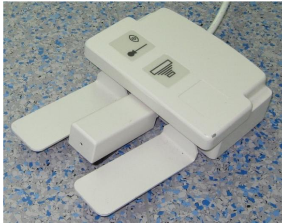
Figura 14b. Pedal para selección y emisión en fluoroscopia y adquisición de imagen (cine).
