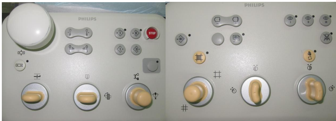
Figuras 14c y 14d. Mandos para selección de ángulación del arco, posición de mesa y panel plano. Mandos para selección de modos de fluoroscopia, magnificación, cuña y colimador del haz.
