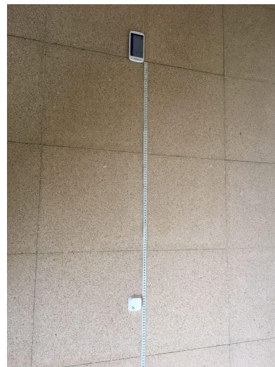
Figura 4.2.3: Toma de medidas con dispositivo Motorola E2 y beacon Kontakt. Lugar: Edificio de Servicios Generales de la EPCC (Planta 2ª)
