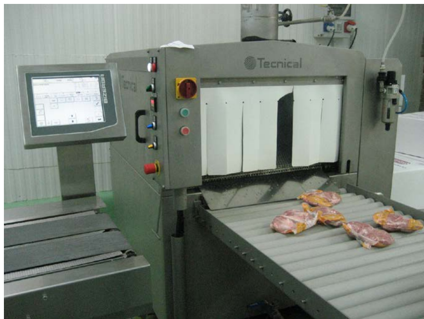
Figura III.1. Túnel de retracción
