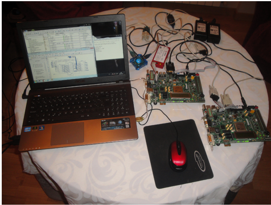
Figura 6.18: Conexión física de las dos tarjetas FPGA emulando el sistema SpaceCube.
