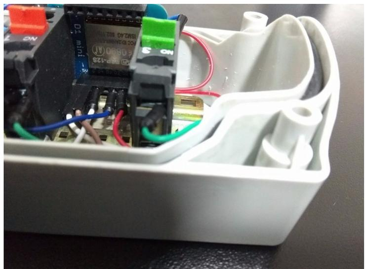
*Ilustración 30: Prototipo Wifi fabricado interior placa*
