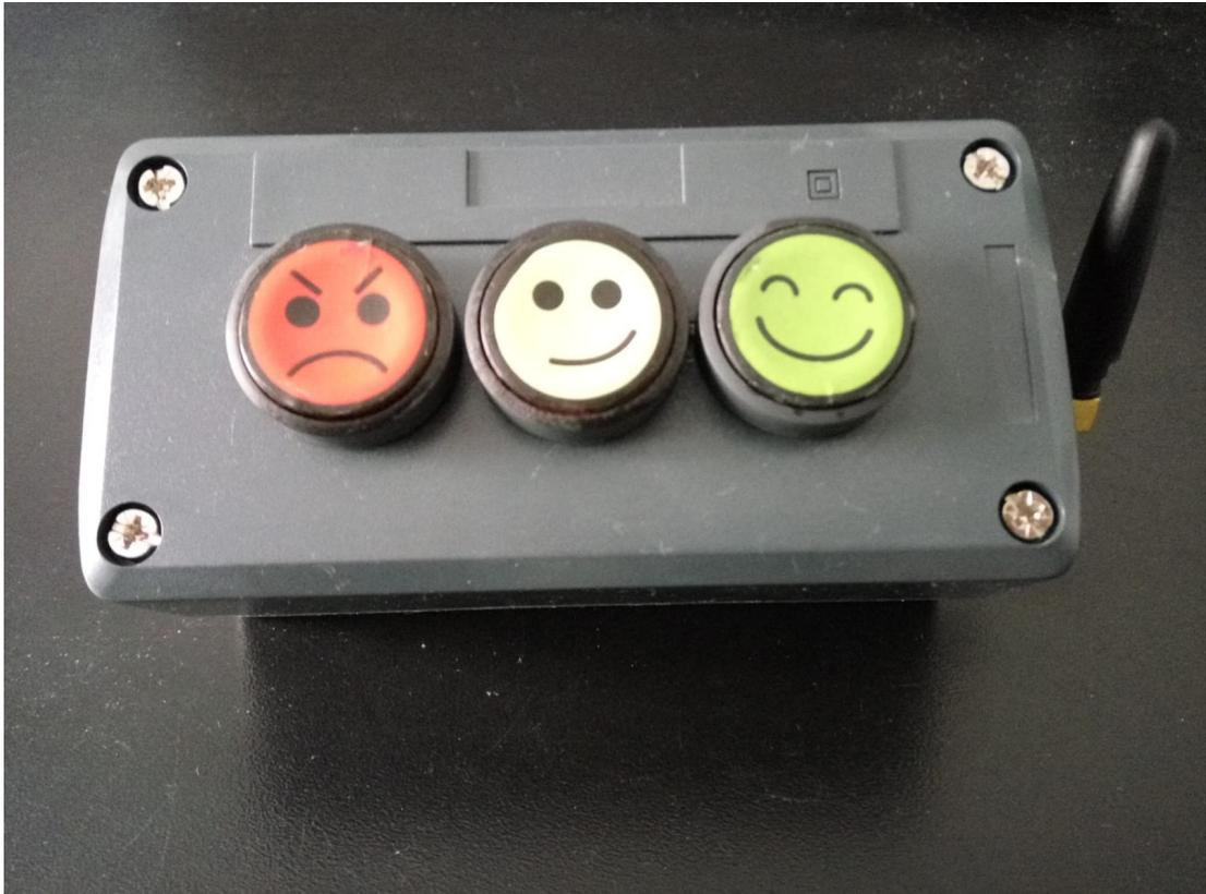
*Ilustración 37: Prototipo GSM fabricado exterior*
