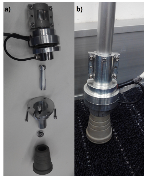
Figura 2: (a) Despiece de las partes mecanizadas. (b) Ensamblaje montado en la muleta.
