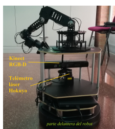
Figura 2: El robot CRUMB y los principales sensores utilizados en este trabajo.
