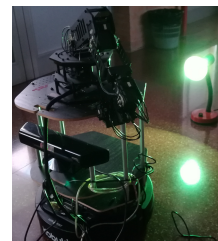
Figura 9: Diseño experimental para la prueba de anomalías por malas condiciones de iluminación. La bombilla queda situada justamente en frente de los sensores.
