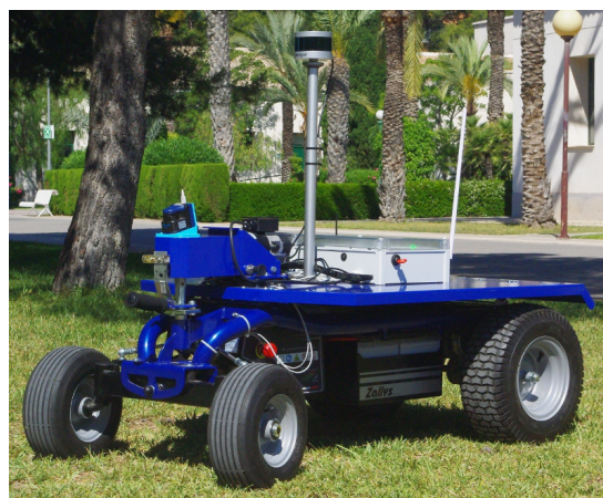
Figura 1: Vehículo terrestre no tripulado empleado para la evaluación del sistema de RTK u-blox C94-M8P.
