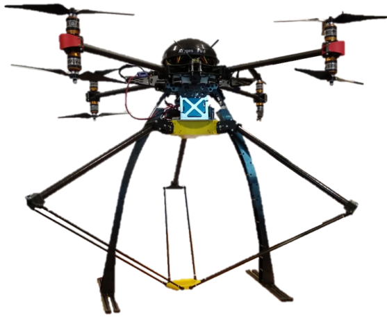
Figura 10: Fotografía del conjunto: UAV con manipulador paralelo acoplado y patas retráctiles en posición para el despegue y aterrizaje.
