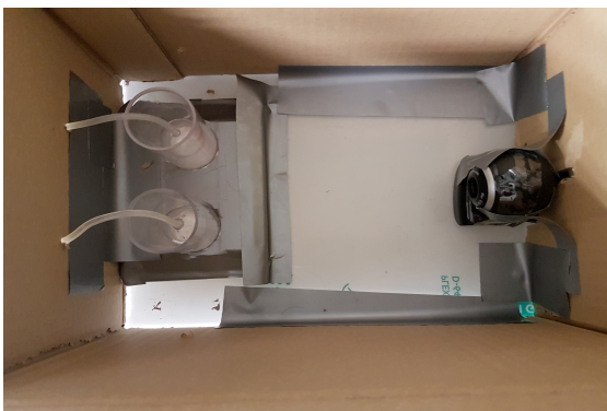
Figura 6: Sistema de visión depósito de hidrógeno.
