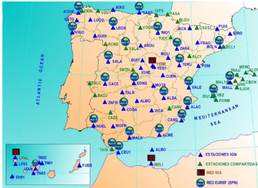
Figura 5: Red de estaciones permanentes ERGNSS [6]
